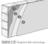
● 基层:厦光中层柔性腻子/厦光专用中层腻子2道 ② 底漆:厦光抗碱封闭底漆/厦光渗透型封闭底漆1道 ③ 造型层:厦光弹性中层主漆1道
