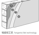
● 基层:厦光中层柔性腻子/厦光专用中层腻子2道 ② 底漆:厦光抗碱封闭底漆1道 ③ 造型层:厦光弹性中层主漆1道
