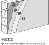
● 基层: 厦光中层柔性腻子/厦光专用中层腻子2道 ❷ 底漆: 厦光坑礁封闭底漆/厦光含砂专用封闭底漆1道 ❸ 主材: 厦光质感涂料1~2道 ④ 罩面: 厦光层感涂料1~2道
