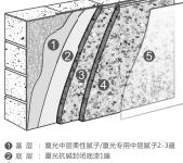
2 底 层 : 厦光抗碱封闭底漆1遍3 中层一 : 厦光CDS天然真石漆1遍4 中层二 : 厦光CDS天然真石漆1遍 6 面 层 : 厦光罩面涂料1-2遍
